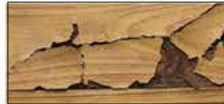
Without Epoxy Block Primer
